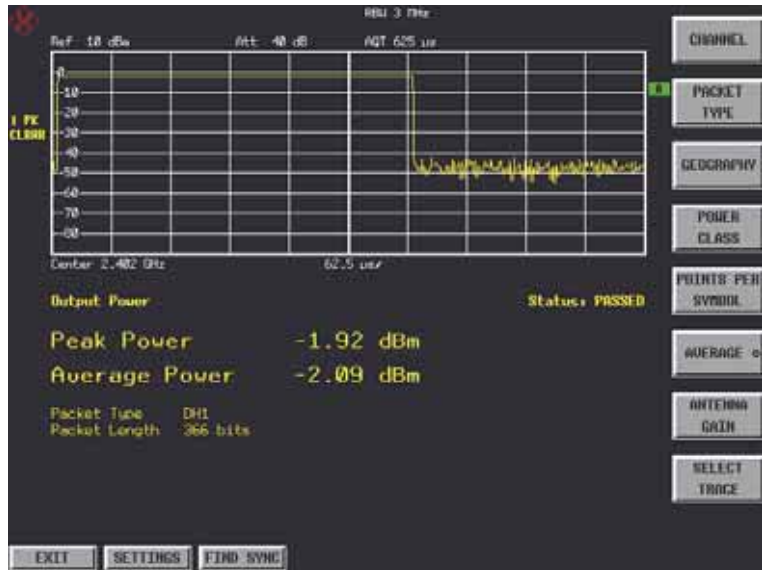
Abb. 1: Messung der Ausgangsleistung
